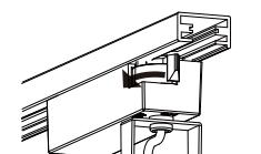
2.本体を持ったまま右図のように先にレバー側を傾けてツメが配線ダクトからはずされたことを確認してゆっくり器具を下へはずしてください。
