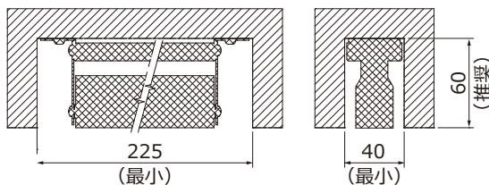
器具寿命・安全を考慮した最小寸法です。実際の施工ではメンテナンスも配慮し、より広い開口寸法を推奨します。
