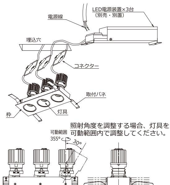
△ 指定の可動範囲以上、無理に可動させないでください。器具破損、器具落下の原因となります。
