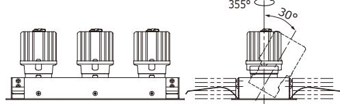
△ 指定の可動範囲以上、無理に可動させないでください。器具破損、器具落下の原因となります。
