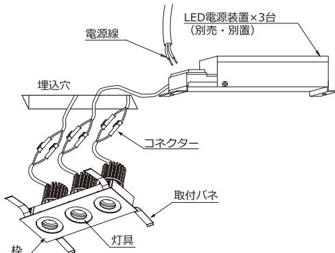
照射角度を調整する場合、灯具を可動範囲内で調整してください。可動範囲
