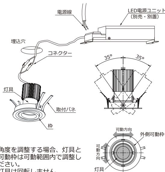
照射角度を調整する場合、灯具と外側可動枠は可動範囲内で調整してください。
