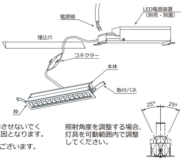
△ 指定の可動範囲以上、無理に可動させないでください。器具破損、器具落下の原因となります。
