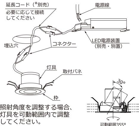
△ 指定の可動範囲以上、無理に可動させないでください。器具破損、器具落下の原因となります。
