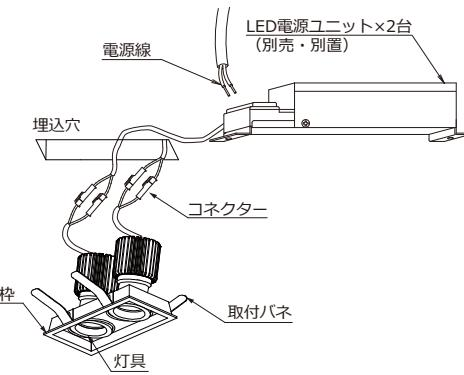
照射角度を調整する場合、灯具を可動範囲内で調整してください。
