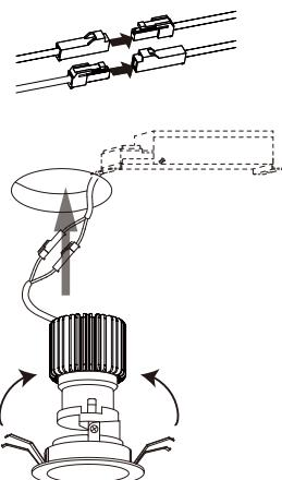
6. 枠の取付バネをせばめて埋込穴に挿入し電線やコネクターが挟まらないよう本体を真っすぐ押し上げて取り付けてください。
