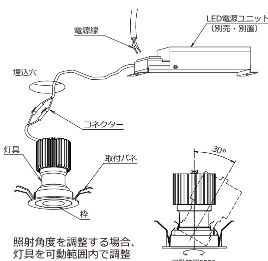
△ 指定の可動範囲以上、無理に可動させないでください。器具破損、器具落下の原因となります。
