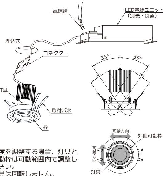
照射角度を調整する場合、灯具と外側可動枠は可動範囲内で調整してください。
