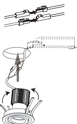
6. 枠の取付バネをせばめて埋込穴に挿入し電線やコネクターが挟まらないよう灯具を真っすぐ押し上げて取り付けてください。
