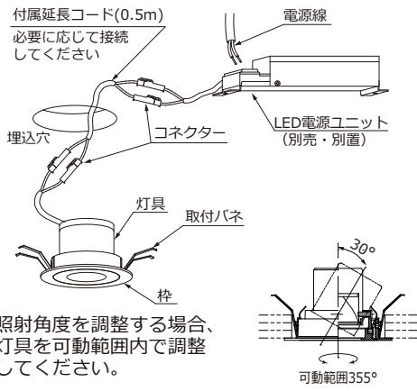
△指定の可動範囲以上、無理に可動させないでください。器具破損、器具落下的原因となります。
