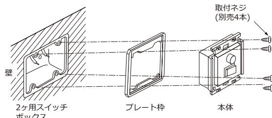
△注意 取付ネジを締め込みすぎると本体が変形し、プレートが取り付かない場合があります。
