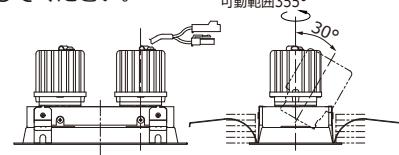
△ 指定の可動範囲以上、無理に可動させないでください。器具破損、器具落下の原因となります。
