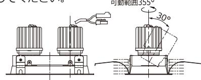
△ 指定の可動範囲以上、無理に可動させないでください。器具破損、器具落下の原因となります。
