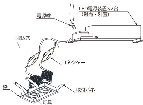
照射角度を調整する場合、灯具を可動範囲内で調整してください。
