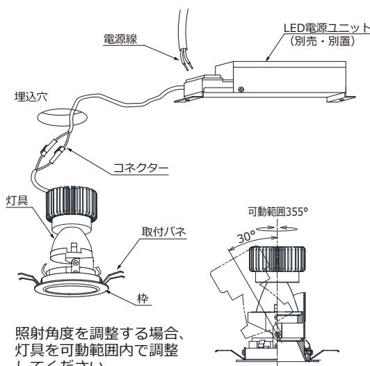
△ 指定の可動範囲以上、無理に可動させないでください。器具破損、器具落下の原因となります。
